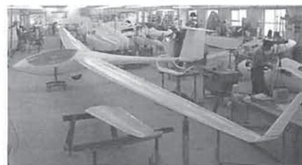
Het prototype van de ASW 28-18 met de 18-m-tip geplaatst. Op de voorgrond de 15-m-tip. (bedrijfsfoto)
