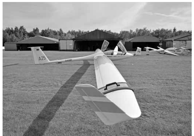
Deze AS H25 tweezitter komt net als de oudere ASK-13 uit de Schleicher-stal. Alexander Schleicher Segelflugzeugbau bestaat al sinds 1927 en is dan ook een referentie. Met een spanwijdte van 26 meter is deze privé-tweezitter hier de grootste en zijn glide ratio van 1 op 60 maakt dat hij ook de scherpste is. Een intrekbaar landingsgestel en inklapbare 'thuiswerker' Rotax-motor met 275 cc cilinderinhoud zorgen voor extra veiligheid en vluchtduur.
